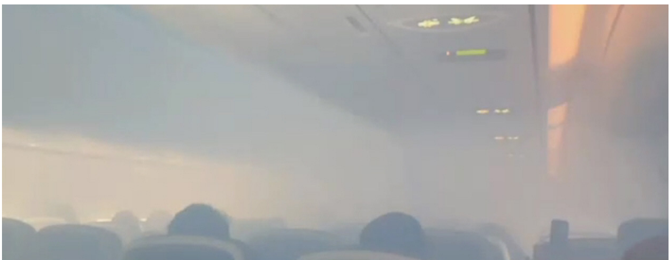
2019-08-22, Hawaiian Airlines HA47, A321neo. Notlandung und Evakuierung nach Rauch an Bord. Ursache: Dichtungsschaden im linken Motor. Bildquelle: Glen Westenskow. Mehr auf https://purl.org/cabinair/HA47
