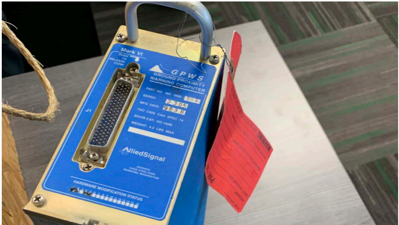
Abbildung 3: GPWS Versandfertig fürs "Bench-Testing".
