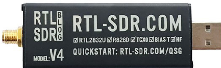
Darstellung eines USB-SDR-Sticks (Quelle: Hersteller)
